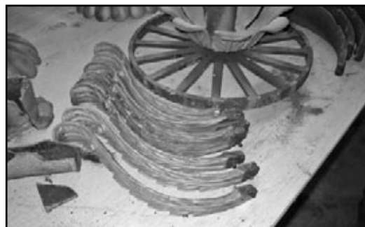
Composantes fortement attaquées par la corrosion. Photo : Jean-François Cossette
