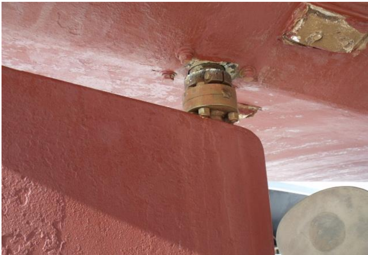
Photo 25 : Vue attachement du gouvernail.
