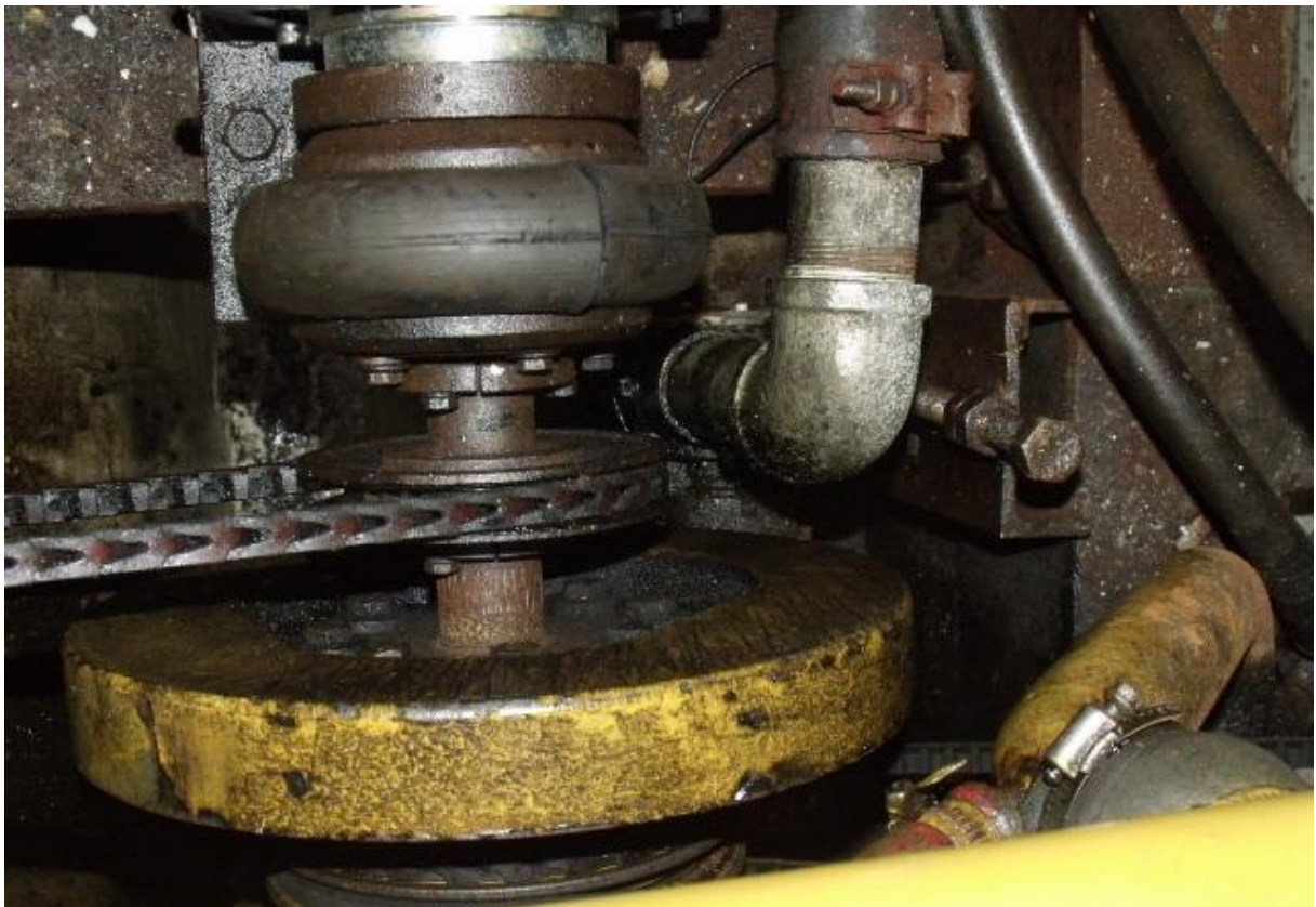
Photo 20 : Pompe de bouchain et de cale et système d'entraînement
