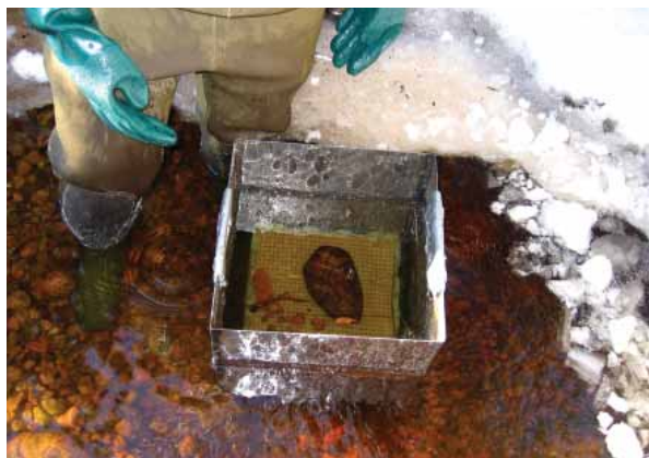
Boîte d'incubation installée sur une frayère
