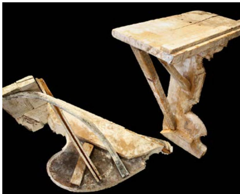
Moules utilisés pour la réalisation des moulures des plafonds des 2 e et 3 e étages.
