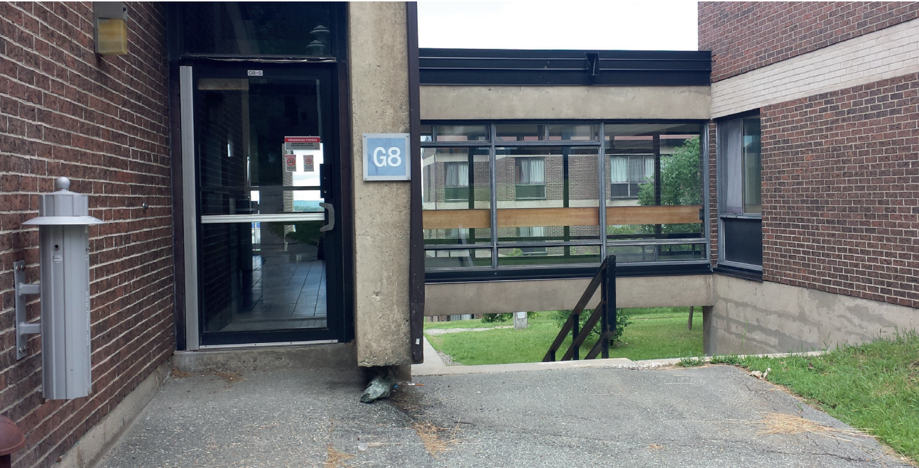
Figure 2 Les portes et les parois vitrées améliorent la visibilité de l'ensemble. Par contre, il faut éviter de placer une porte en retrait, car cela forme une alcôve qui peut créer une cachette à proximité de la zone étagée de circulation.
