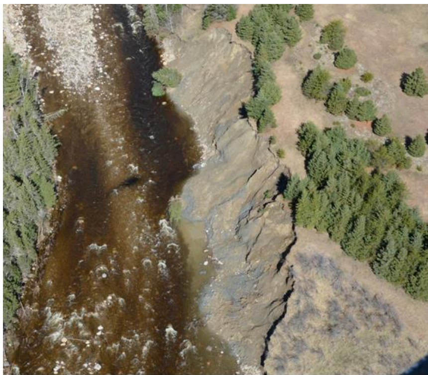
Figure 26. Exemple d'érosion ou de glissements superficiels dans l'argile en rive gauche de la rivière Le Gros Bras à Saint-Urbain en aval du pont de la route 381. À noter que plusieurs glissements superficiels successifs entretenus par l'érosion, qui fut très active le 1 er mai 2023, semblent s'être produits dans la pente (photo MTMD – 2023-05-05)
