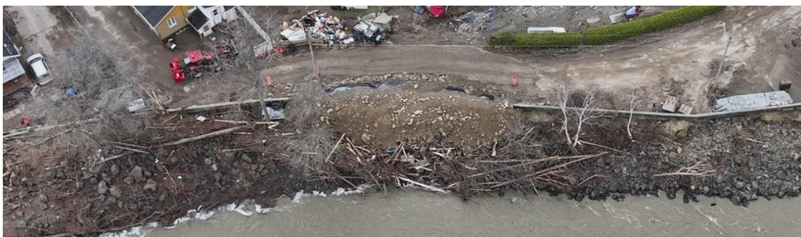
Figure 13. Vue d'une portion du mur côté rue Ménard à Baie-Saint-Paul (au centre, le remblai correspond à une réparation d'urgence)
