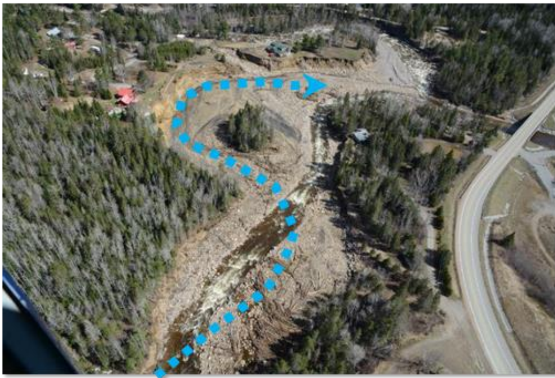
Figure 25. Exemple d'avulsion de la rivière Le Petit Bras à Saint-Urbain. La ligne pointillée bleue avec la flèche indique la position approximative de la rivière avant le 1 er mai 2023 (photo MTMD – 2023-05-05)
