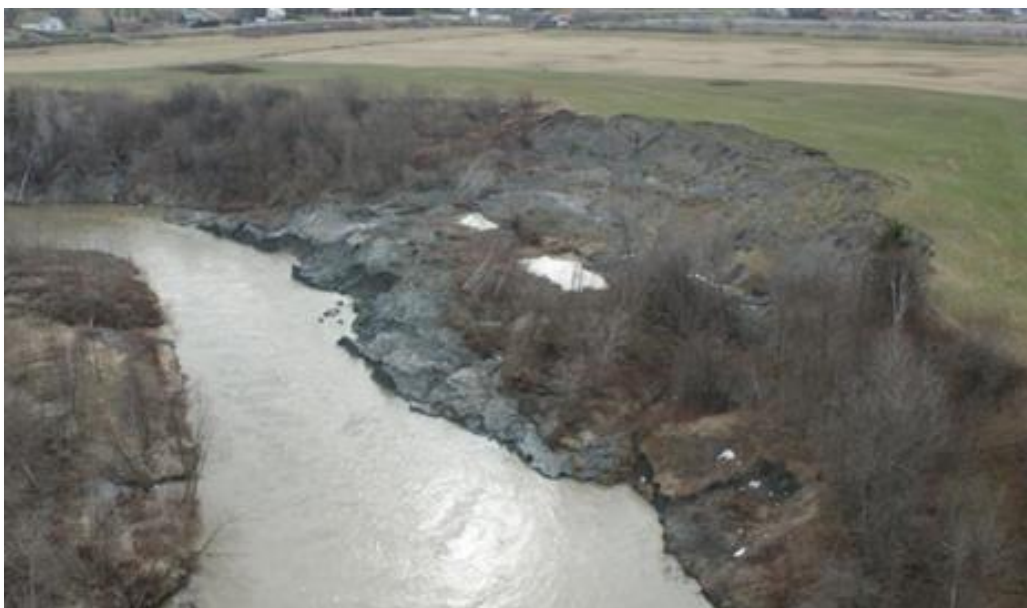
Figure 29. Exemple d'un glissement fortement rétrogressif qui s'est produit au printemps 2013 dans les dépôts silto-argileux en rive gauche de la rivière du Gouffre en zone agricole à Baie-Saint-Paul (photo MTMD – 2013-05-02)
