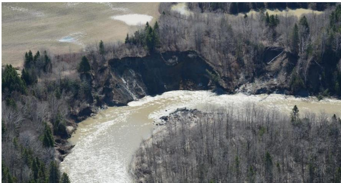
Figure 27. Exemple d'érosion ou de glissements rotationnels dans des dépôts silto-argileux en rive gauche de la rivière du Gouffre en zone agricole, environ 2,5 km en amont du secteur urbain de Baie-Saint-Paul (photo MTMD – 2023-05-05)
