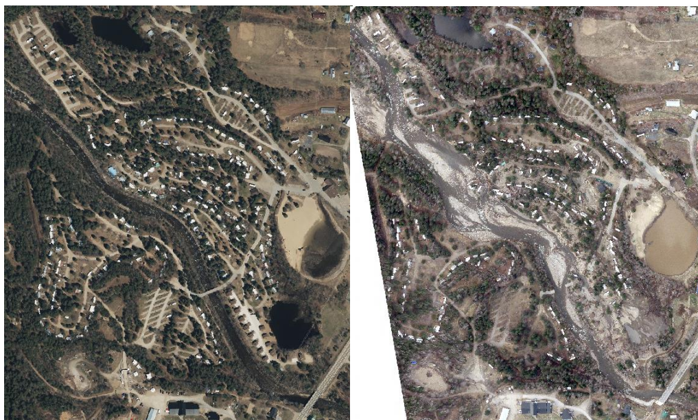
Figure 49. Comparaison du tracé de la rivière des Mares avant (2018 à gauche) et après l'événement du 1 er mai (2023 à droite)
