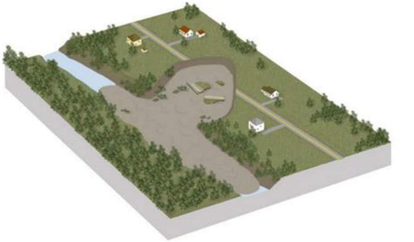
Figure 5. Vue en perspective d'un glissement de terrain fortement rétrogressif
