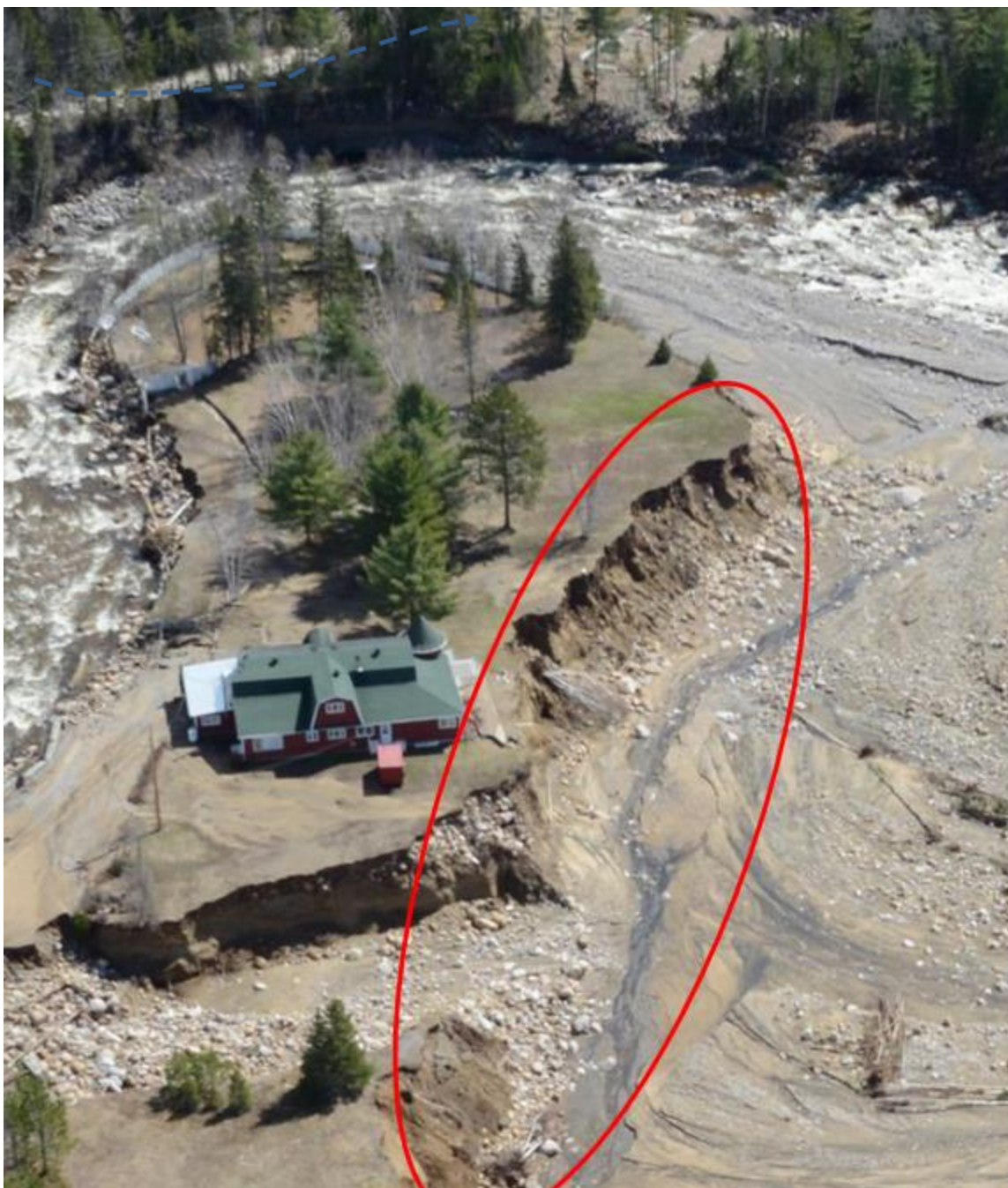
Figure 28. Exemple d'érosion ou de glissements superficiels dans des dépôts granulaires en rive gauche de la rivière Le Petit Bras à Saint-Urbain en amont du pont de la route 381. À noter que plusieurs glissements superficiels successifs entretenus par l'érosion, qui fut très active le 1 er mai 2023, se sont produits dans la pente. La flèche bleue indique un nouveau chenal temporaire que la rivière s'est creusé sur plusieurs mètres de profondeur lors de la crue du 1 er mai, et qui a été abandonné lors de la décrue (photo MTMD – 2023-05-05)
