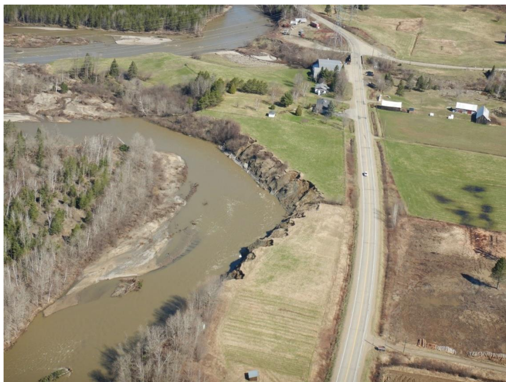
Figure 30. Exemple d'un méandre de la rivière du Gouffre où la berge s'est déplacée latéralement de quelques dizaines de mètres depuis 2004, sous l'effet de l'érosion, se rapprochant progressivement du chemin du rang Saint-Laurent, à Baie-Saint-Paul (photo MTMD – 2023-05-05)
