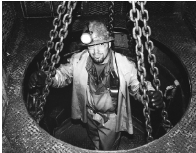
Photo : Denis Bernier Le cuffat a une profondeur d'environ deux mètres. Si ce n'était du faux plancher sur lequel il se tient, Sylvain Gélinas, mineur chez Ross-Finlay 2000, disparaîtrait au fond du cuffat.
