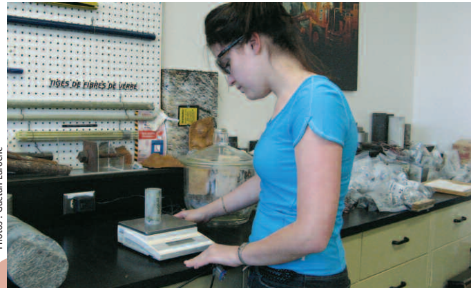
L'étudiante sur la photo pèse un échantillon de roche cylindrique pour en déterminer la masse.
