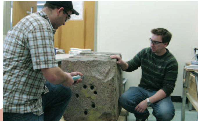
Les étudiants mesurent des valeurs de rebondissement à l'aide d'un marteau Schmidt. Cet appareil, portable et simple d'utilisation, permet l'évaluation non destructive de la résistance en compression de la roche. La hauteur du rebond mesurée est proportionnelle à la dureté de la surface testée.
